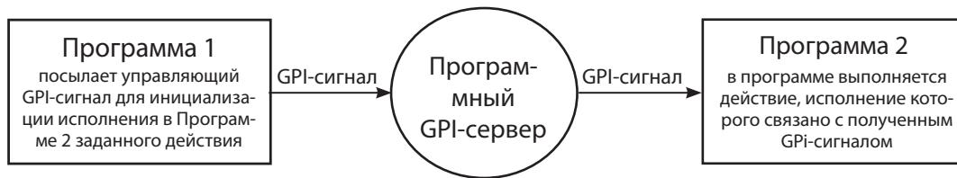
Для передачи управляющего сигнала из одной программы в другую используется пара GPI-сигналов – выходной и входной:
