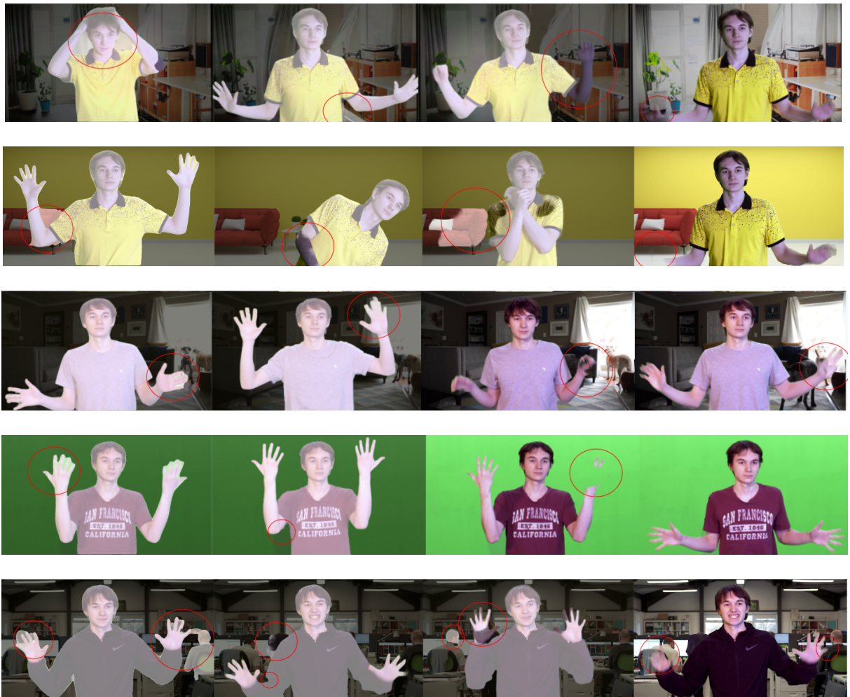
Рис. 20. Характерные дефекты для четырех алгоритмов выделения актера для различной одежды актера на разных фоновых изображениях:
